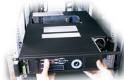
Die Schrauben links und rechts lösen und das Modul herausnehmen.
